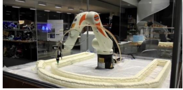
Εικόνα 1: Ενδεικτικές εφαρμογές τρισδιάστατων εκτυπωτών κτηρίων – εργαστηριακές εφαρμογές (επάνω) και προτεινόμενες λύσεις (conceptual designs – κάτω)
