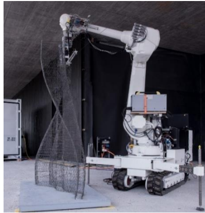
Εικόνα 2: Φορητό ρομπότ ψεκασμού κονιαμάτων - ETH Zurich
