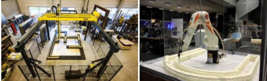
Εικόνα 1: Ενδεικτικές εφαρμογές τρισδιάστατων εκτυπωτών κτηρίων.
