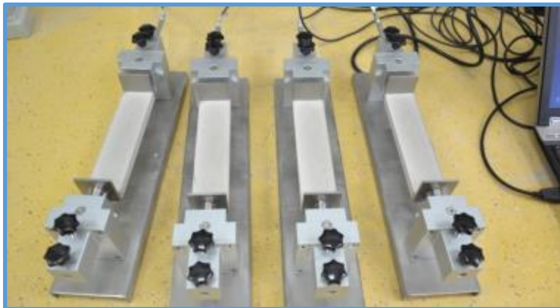
Εικόνα 3.3 : Συσκευή μέτρησης πρώιμης συρρίκνωσης της Σίκα σε πρίσματα 40x40x160 cm.
