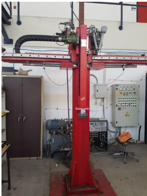
Εικόνα 3.1: Καρτεσιανό ρομπότ ΕΣΜ – ΕΜΠ πριν την αναβάθμισή του
