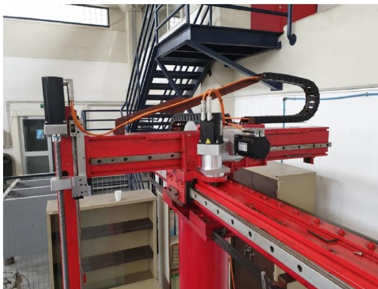
Εικόνα 3.3: Καρτεσιανό ρομπότ ΕΣΜ – ΕΜΠ μετά την αναβάθμιση
