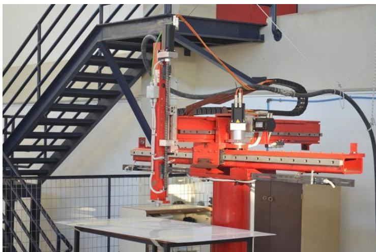
Εικόνα 3.2: Καρτεσιανό ρομπότ ΕΣΜ – ΕΜΠ μετά την αναβάθμιση
