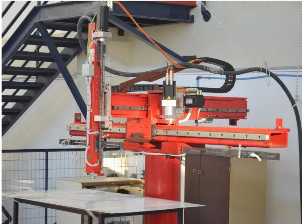
Εικόνα 3: Καρτεσιανό ρομπότ Εργαστηρίου Δυναμικής & Κατασκευών ΕΜΠ, εν ώρα λειτουργίας για το πρόγραμμα 3BUILD
