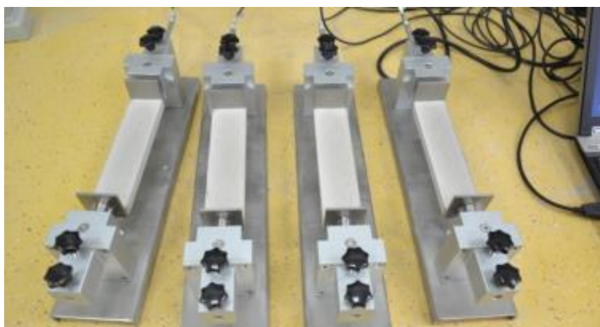
Εικόνα 1 : Συσκευή μέτρησης πρώιμης συρρίκνωσης της Sika σε πρίσματα 40x40x160 cm.
