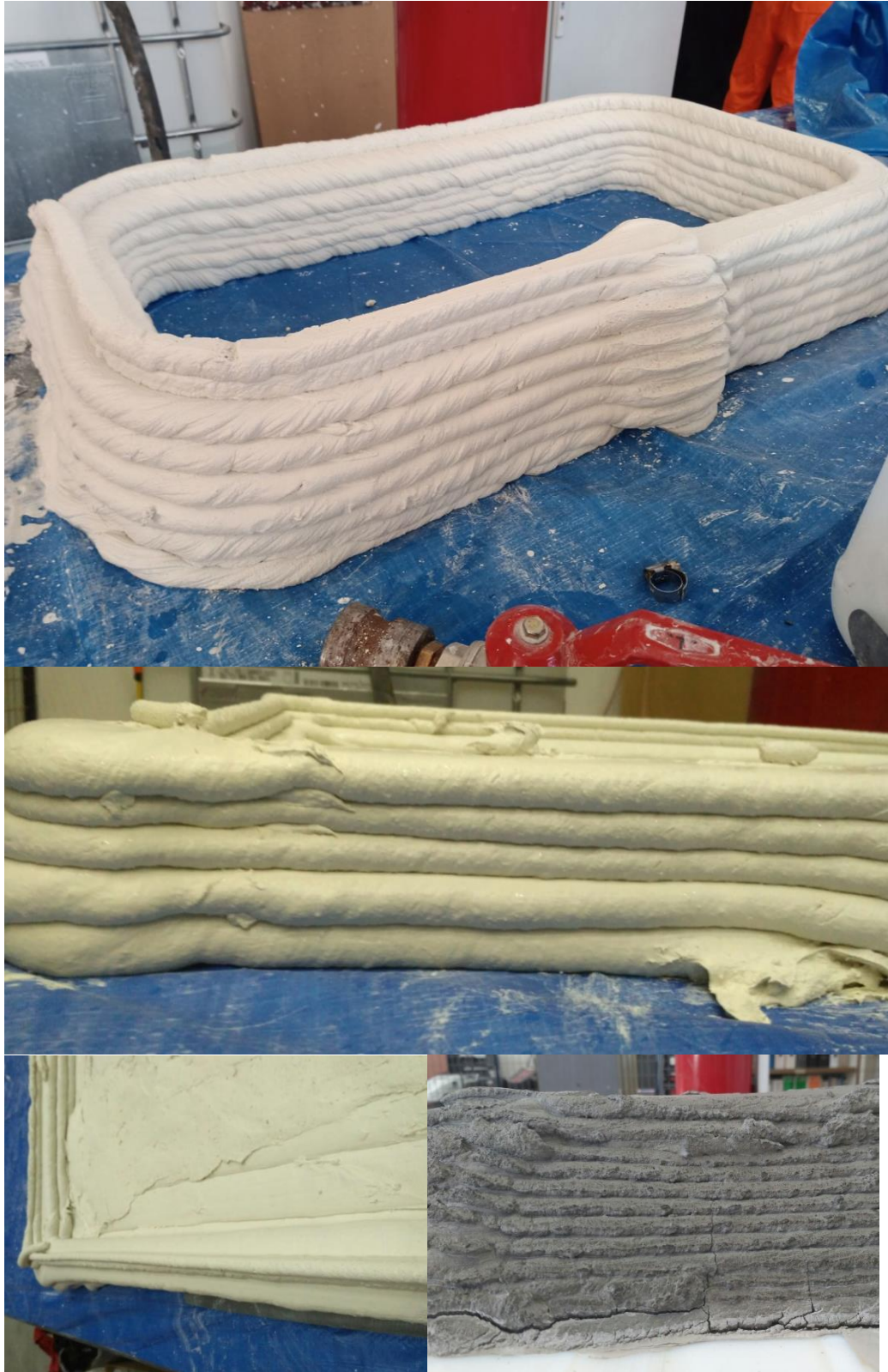
Εικόνα 6: Στιγμιότυπα εκτυπώσεων εκτυπωτή ημίσειας κλίμακας
